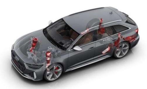
Die serienmässige Luftfederung <u>RS-adaptive air suspension</u> mit geregelter Dämpfung wurde RS-spezifisch abgestimmt und lässt den RS 6 Avant und RS 6 Avant performance dank eines Luftfedermoduls mit einer um 50 Prozent höheren Federrate erstmals bis zu 305 km/h schnell werden (mit Dynamikpaket plus). Sie lässt sich in mehreren Modi einstellen und integriert einen automatischen Niveauausgleich.
