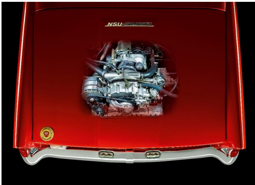
Der Wankel-Motor im weltweit ersten serienmäßigen Wankel-Modell, dem NSU/Wankel Spider.
