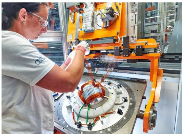
In Győr ist die Serienproduktion von Elektroantrieben offiziell gestartet. Auf 8.500 Quadratmetern entstehen die Elektroantriebe nach einem neuartigen Produktionskonzept, der modularen Montage.
