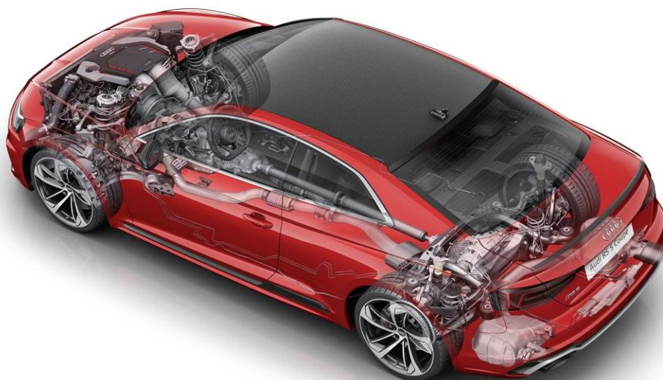
Die **radselektive Momentensteuerung** rundet die Arbeit des quattro-Antriebs ab. Bei schneller Kurvenfahrt verzögert sie die kurveninneren Räder mit fein dosierten Bremsengriffen, bevor sie durchrutschen können. Die Differenz der Vortriebskräfte lässt das Auto ganz leicht in die Kurve eindrehen – Agilität, Präzision und Stabilität werden nochmals gesteigert.
